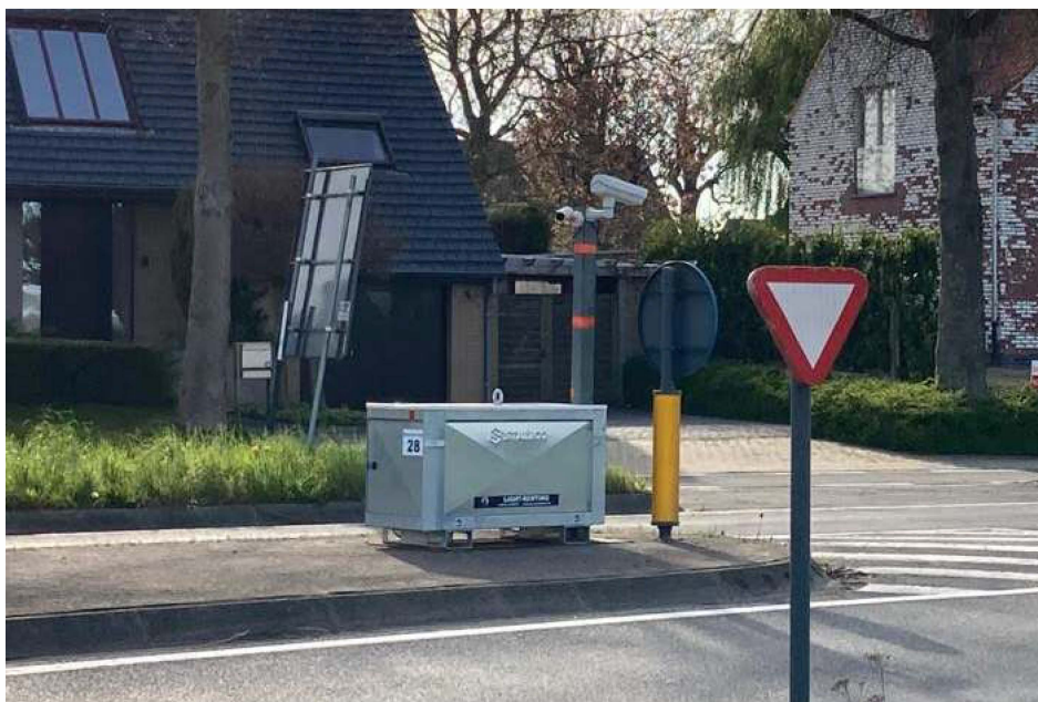
Figuur 50: Een telpost met camera ter hoogte van de Wakkensesteenweg richting centrum
